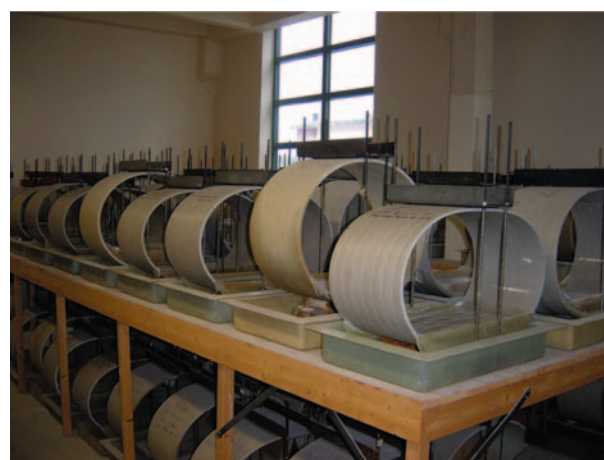
Рис. 1 Аппаратура для коррозионных испытания напряженных образцов
