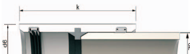
Муфта для безнапорных труб PN1 Flowtite для номинальных диаметров DN 300-3000
