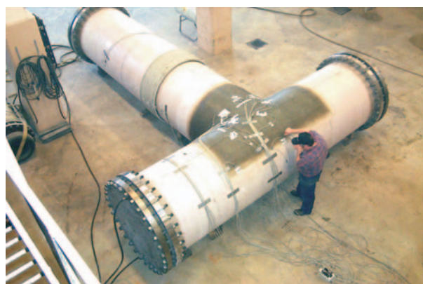
Испытания ламинированного соединения напорного тройника DN 1200/1200, PN 6
