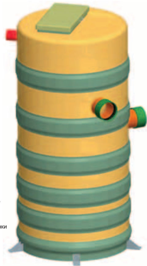
Рисунок 3-2-1 Возможное решение для размещения насосной станции в стеклопластиковом смотровом колодце в зонах без нагрузки транспорта, основанное на тонкостенной стеклопластиковой трубе, укрепленной ребрами
