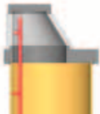
Рисунок 4-1-3-1 Бетонные крышки с интегрированным кольцом основания для стандартных конусов
