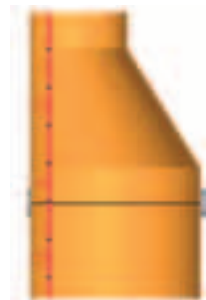
Рисунок 4-1-3-3 Шахтный ствол, оборудованный стеклопластиковым переходником
