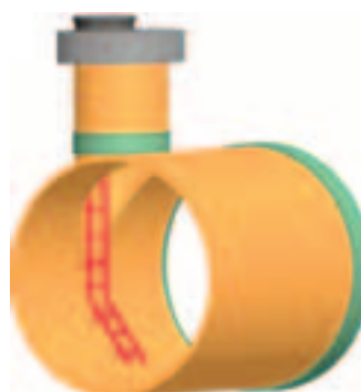
Рисунок 4-4-2 Тангенциальный смотровой колодец с изогнутой лестницей
