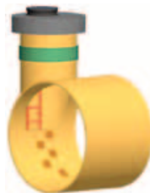
Рисунок 4-4-1 Тангенциальный смотровой колодец с коробкой ступенек
