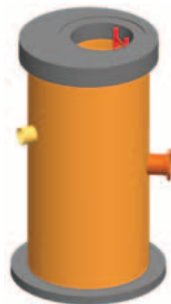
Рисунок 3-2-2 Возможное решение для размещения насосной станции в стеклопластиковом смотровом колодце, основанное на обычной стеклопластиковой трубе
