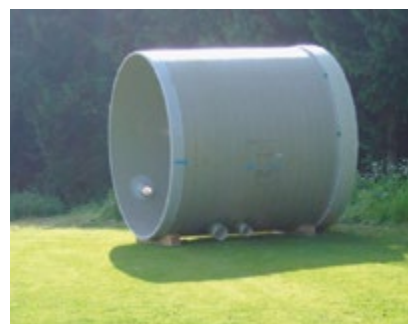
Рис. 2.8 | Складирование горизонтальных колодцев
