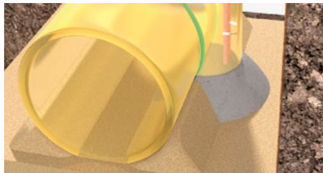
Рис. 3.6 | Бетонное наполнение под основанием
