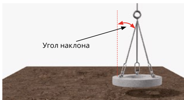
Рис. 3.10 | Подъем ж/бетонной крышки
