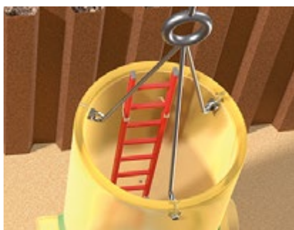
Рис. 2.3 | Подвешенная конструкция колодца
