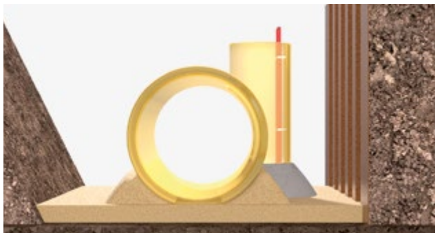
Рис. 3.5 | Бетонное наполнение под основанием
