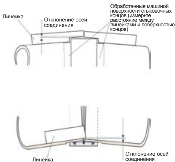
Рисунок 3-10 Отклонение осей соединения
