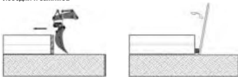
**Рис. 8** Соединение труб с использованием ковша строительного экскаватора или рычага
